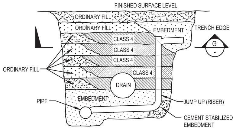
**ELEVATION H - TYPE 4 PROPERTY CONNECTION TRENCH BACKFILL**
