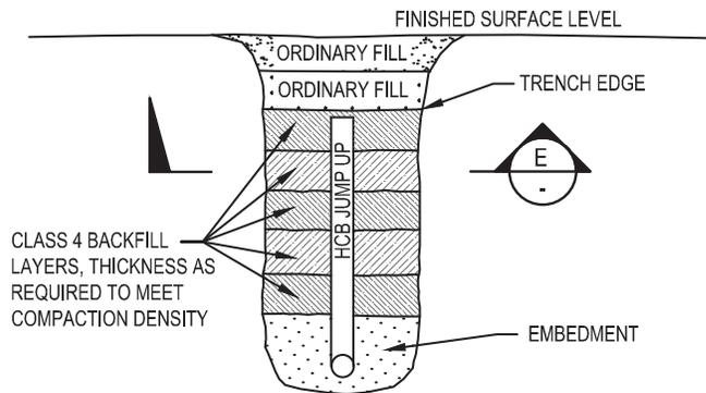
**SECTION I- TYPE 4 PROPERTY CONNECTION TRENCH BACKFILL**
