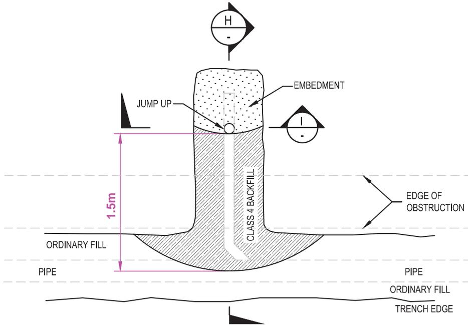
**PLAN VIEW G- TYPE 4 PROPERTY CONNECTION TRENCH BACKFILL**
