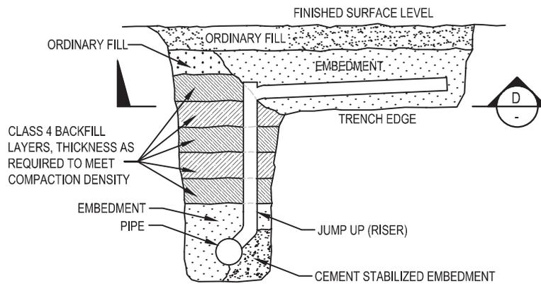
**ELEVATION E - TYPE 2 PROPERTY CONNECTION TRENCH BACKFILL**
