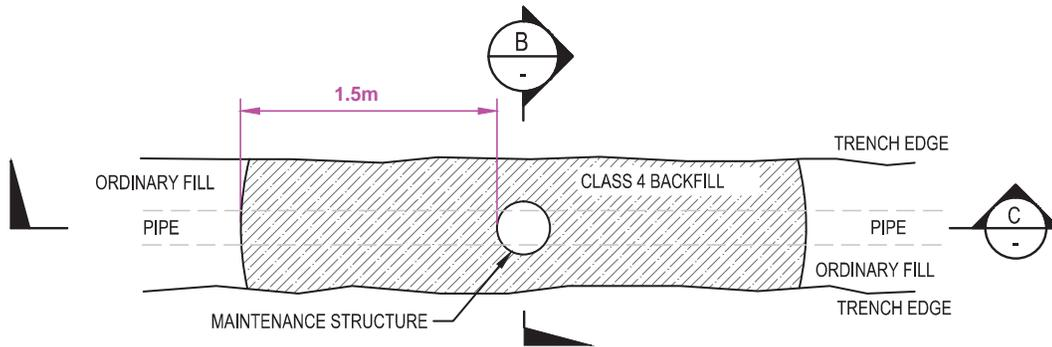
**PLAN VIEW A - MAINTENANCE SHAFT TRENCH BACKFILL**
