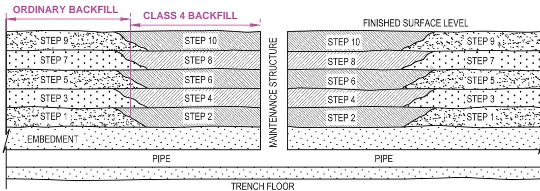
**SECTION C - MAINTENANCE SHAFT TRENCH BACKFILL**
