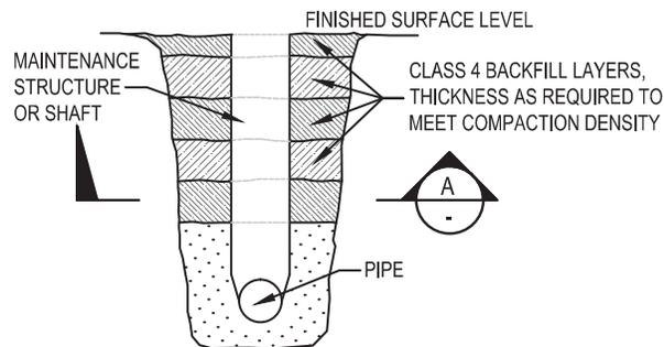
**ELEVATION B - MAINTENANCE SHAFT TRENCH BACKFILL**
